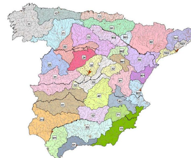
Figura nº 9. Regiones a considerar para la caracterización de coeficiente reductor del umbral de escorrentia
