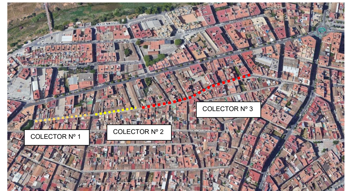
Figura nº 2. Colector de saneamiento.
