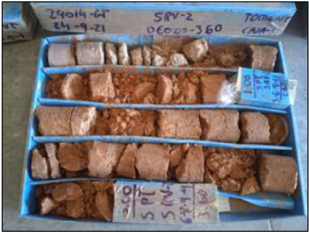
Fotografía 2.- Sondeo 2, caja de 0.00 a 3.60 m
